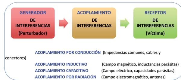
Figura 4: Esquema básico de cualquier problema de CEM.
